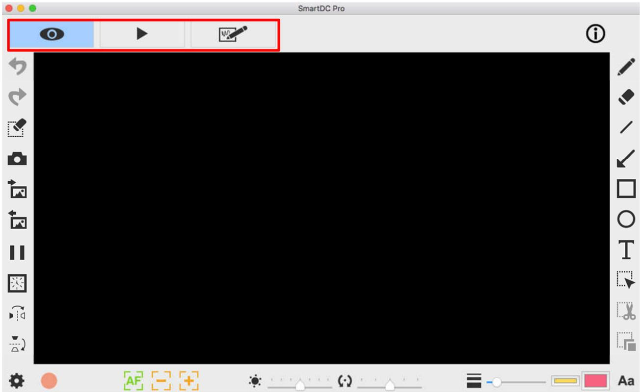
Здесь можно выделить несколько рабочих зон. В центре располагается рабочее окно просмотра, в котором отображаются текущие изображения (в зависимости от режима работы - формируемые камерой, загруженные с компьютера или созданные с помощью программы). Над ним – основное меню выбора режима работы программы:
